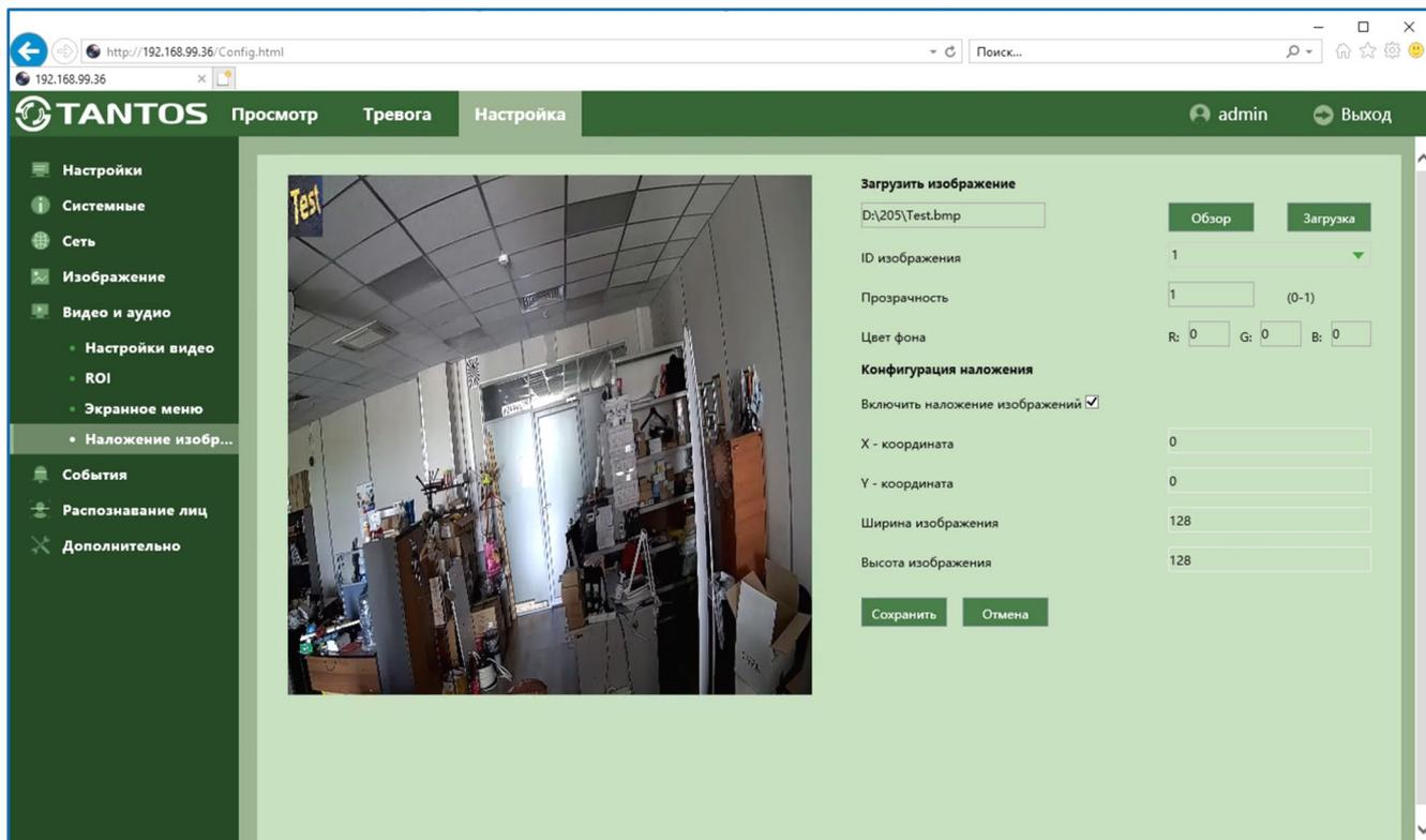
Размер изображения не должен превышать 128x128 пикселей. Изображение должно быть в формате bmp. Изображение накладывается в текущей версии прошивки в левый верхний угол.
