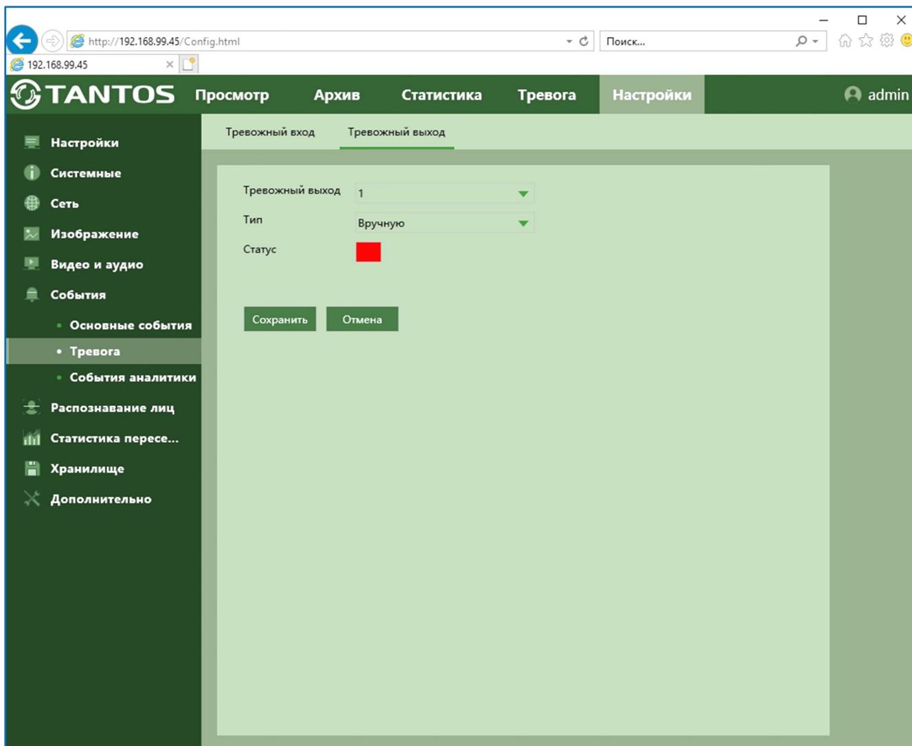
Можно установить работы тревожного выхода по расписанию, вручную или отключить тревожный выход, проверить его состояние.
