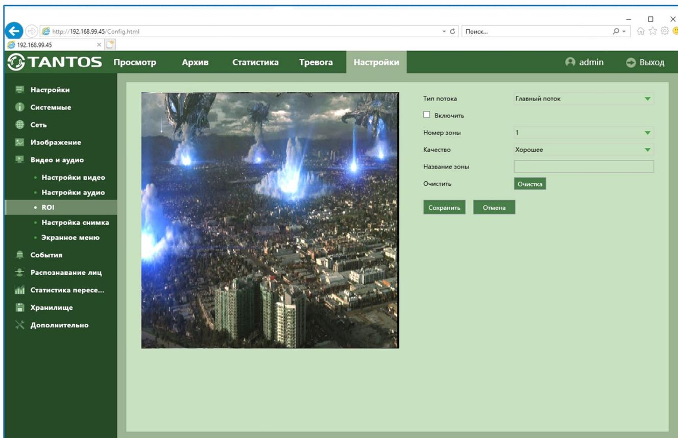
Функция ROI позволяет оптимальным образом сочетать небольшой размер трафика от камеры и высокое качество записи наиболее важных областей изображения.
