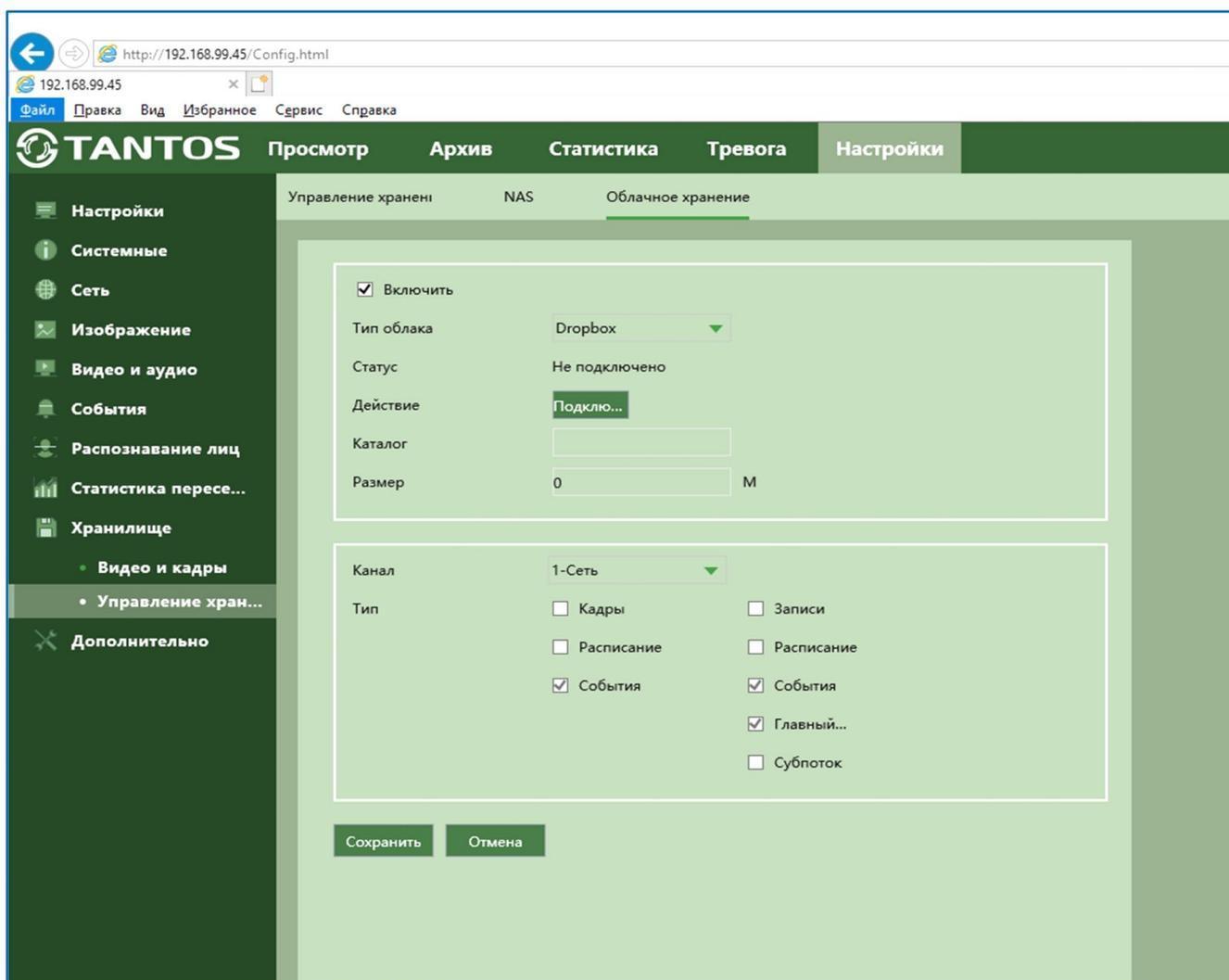
Для использования облачного хранилища Dropbox необходимо завести аккаунт на dropbox.com и при включении отправки файлов на Dropbox быть авторизованным с этим аккаунтом на том устройстве, с которого происходит авторизация (То есть, если Вы настраиваете IP камеру или регистратор с компьютера через браузер, то необходимо, чтобы вы были авторизованы на Dropbox на этом компьютере).
